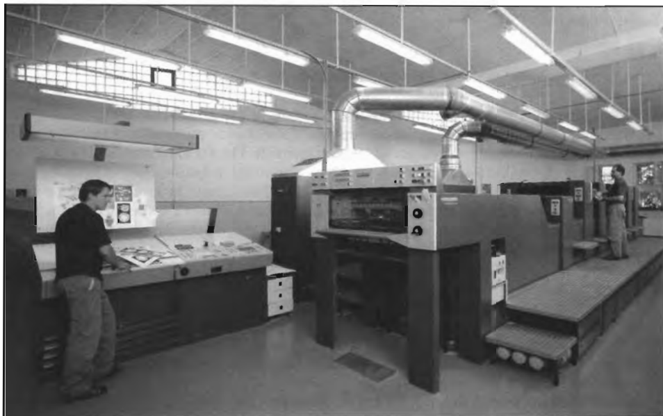
1998. A „nagyberuházás” legjelentősebb berendezése, a 6 színes, lakkozóműves Heidelbergi nyomógép
