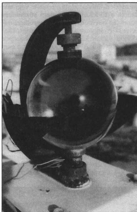
Az állomás Campbell-Stokes-rendszerű üveggolyós napfénytartam-mérője
